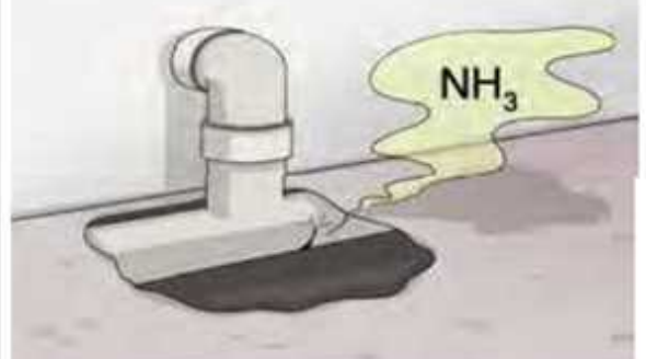
설비 정기점검 부실로 암모니아(NH3)가 누출되어 폭발함
