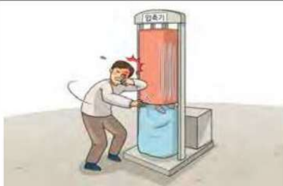
쓰레기 압축작업 중 튀어나온 파편에 맞음
