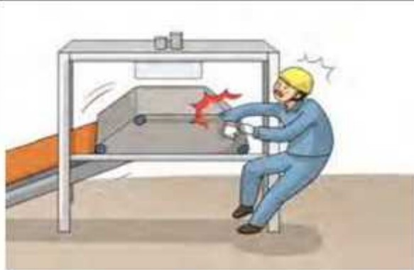
마그네틱 컨베이어 롤러 사이의 이물질 제거 중 끼임
