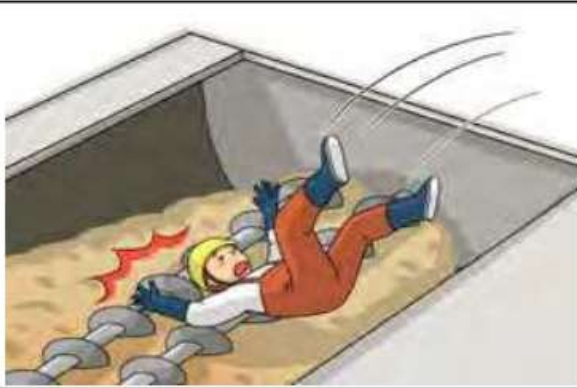
음식물쓰레기 처리시설 호퍼에 떨어져 블레이드에 끼임
