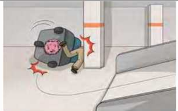
탑승식 청소차로 경사면을 내려오다 전복되어 기동과 청소차 사이에 끼임
