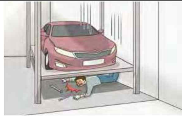
하강하는 리프트의 프레임과 바닥 사이에 끼임
